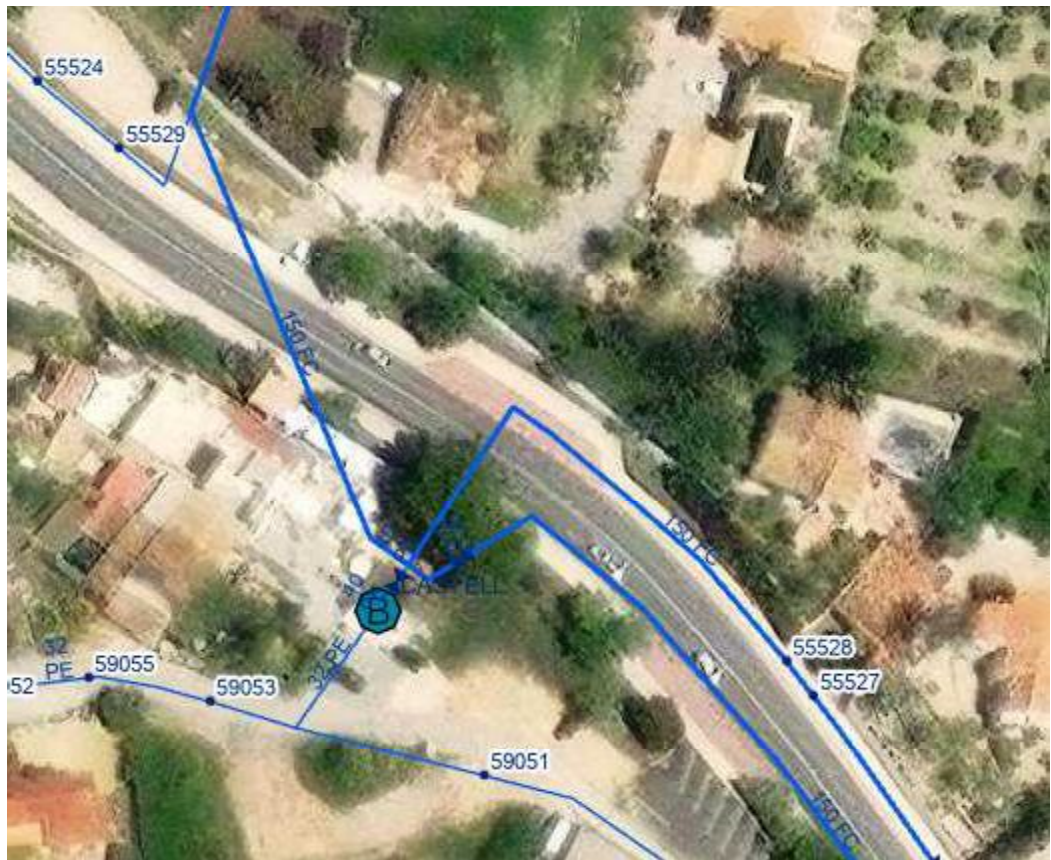
Imagen 1. Tramo de tubería por interior de parcelas privadas
