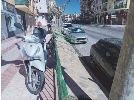
Imagen 3.- Intersección de la calle Ferreria con la calle Riu Algar, en la que se aprecia un pronunciado desnivel entre la calzada y la acera.
